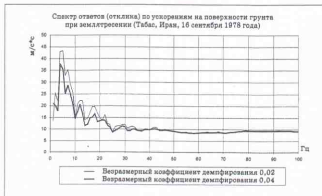
Рис. 3. Акселерограмма колебаний поверхности грунта и соответствующий ей спектр ответов
